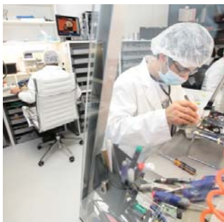
Greffe électromécanique en salle blanche sur un disque dur défectueux.
